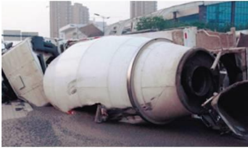
水泥罐车 罐体断裂
